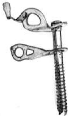
Рисунок 20. Использование ледобура с дополнительной проушиной для карабина
